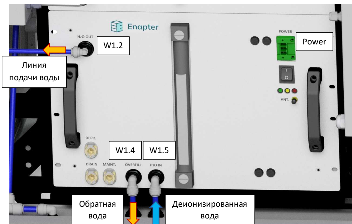
Рисунок 13: Подключения Водяного бака
